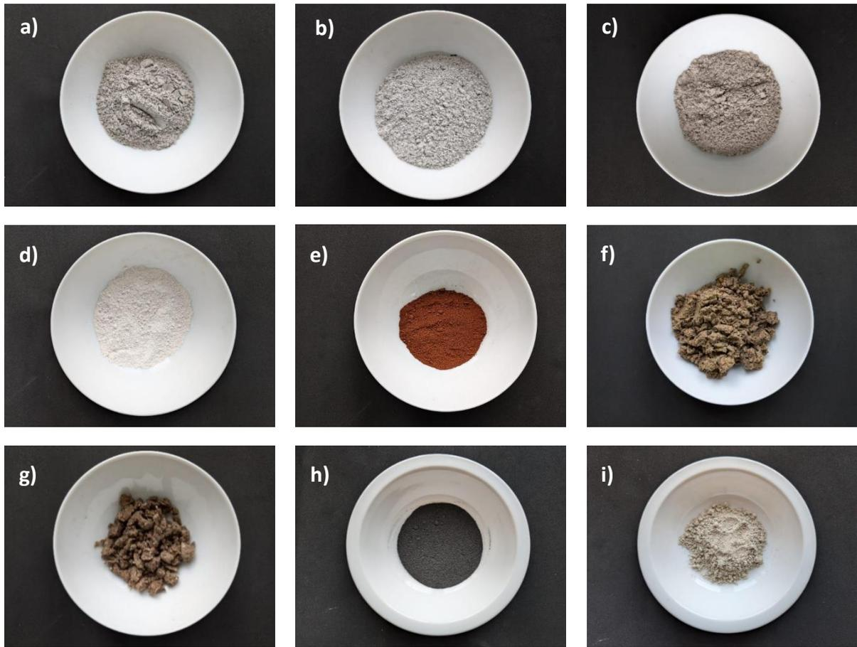
**Figure 3.** a) Biomass ash 1; b) Biomass ash 2; c) Biomass ash 3; d) Concrete powder; e) Red mud; f) Raw olive pomace; g) Raw paper sludge; h) Olive pomace ash; i) Paper sludge ash
